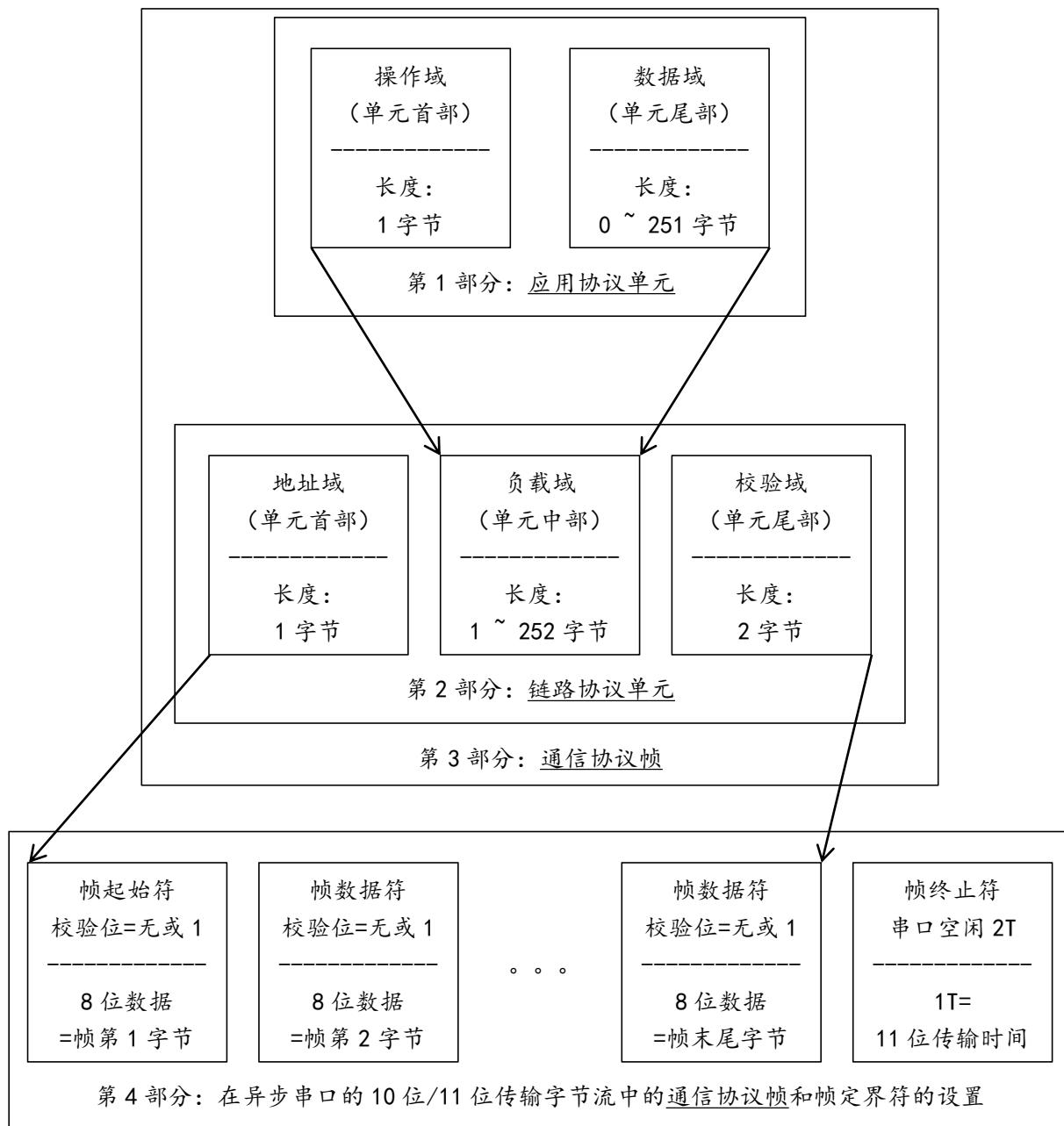
图 3-1: TI0B-T 通信协议帧的结构和传输定界示意
