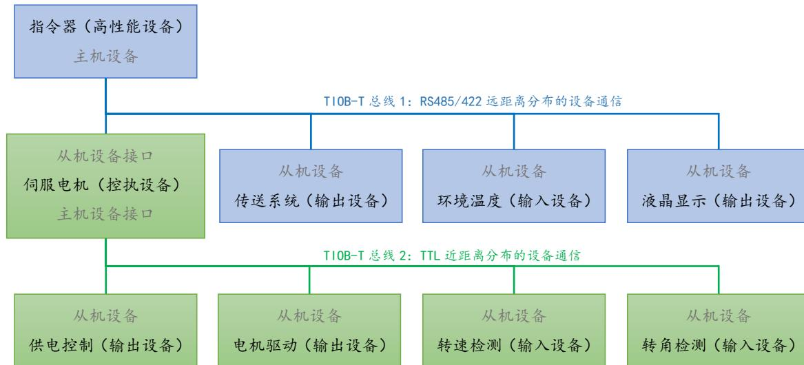
图 2-1: TI0B-T 单主多从拓扑结构示例
